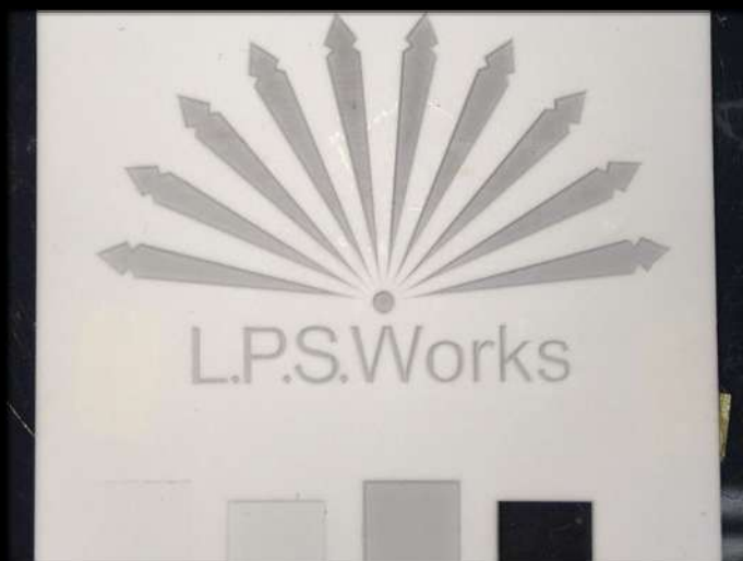
アルミナセラミックスの座繰り加工 深さ：340 \mu\text{m} 板厚：380 \mu\text{m}
